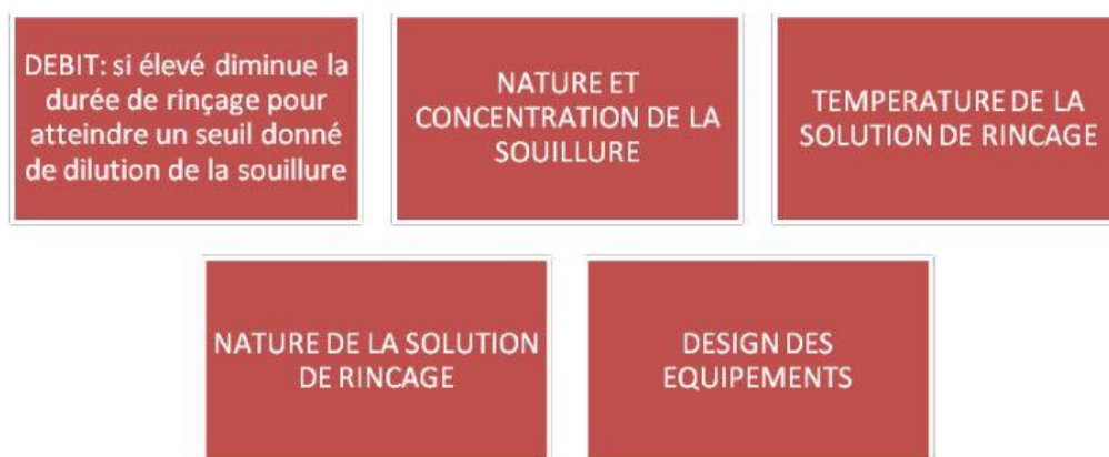
Figure 3: Les paramètres influençant le rinçage [3].
