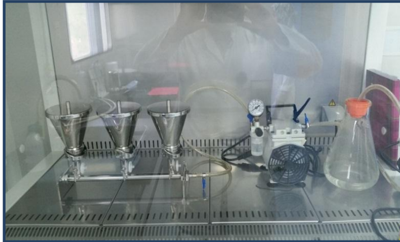
.Figure 8: Rampe de filtration sur membrane
