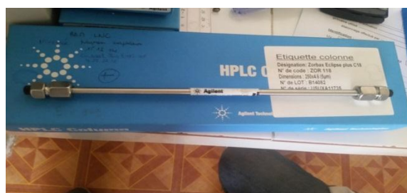
Figure : 7. La phase stationnaire est la colonne (ZORBAX ECLIPSE PLUS C18)
